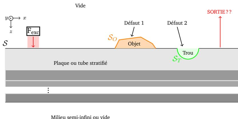
Cette thèse considère deux types de défauts en surface d'un stratifié de forme canonique (plaque, tube, ...). Étant donnée une force d'excitation en entrée, l'objectif est d'obtenir les champs de déplacements et de contraintes en sortie après l'un des défauts.
